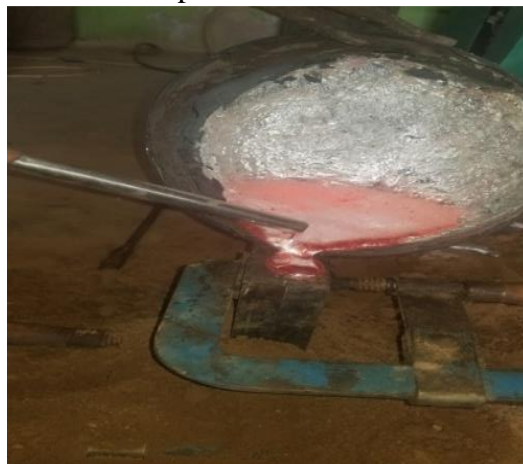
Plate 7. Pouring of molten metals
